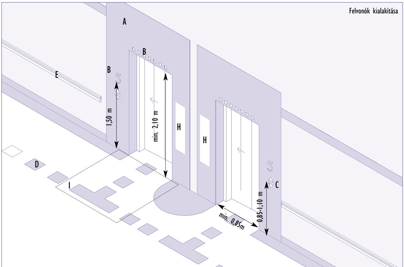
A- Kontrasztos nyílás-szegélyezés, B- Jelzések, C- Kezelőeszközök, D- Burkolati vezetőcsíkok, E- Kapaszkodó korlát, F- Lehajtható ülőke, G- Tükör, H- Információs tábla , I- 1,50x1,50 m méretű vízszintes, szabad terület, J- Kontrasztos sáv
