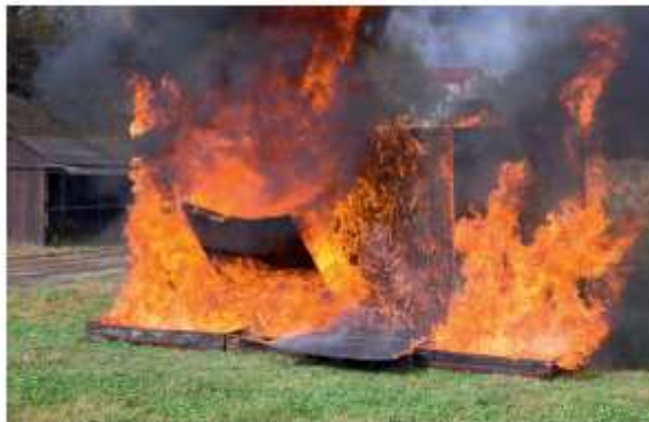
A közetgyapot panel burkolata lehullik, a PIR-en átfut a láng
