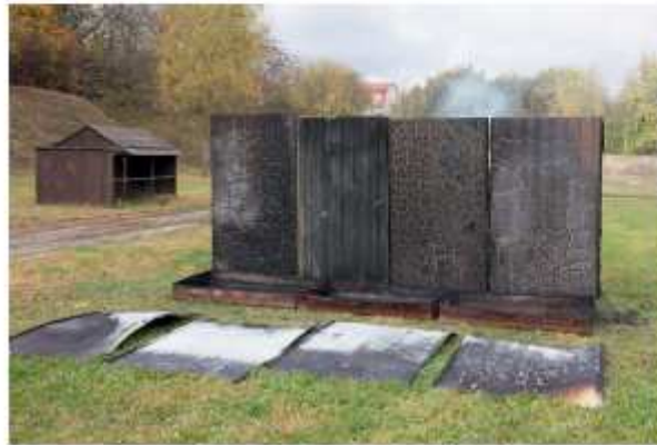
Az IPN és QuadCore paneleken végigfut a láng
