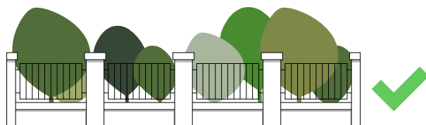
Oszlopos kerítés 1/3-ad lábázat és 2/3-ad áttört résszel.
